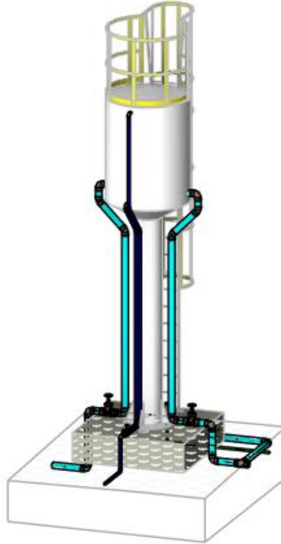
Reservatório tipo taça com coluna seca – 30.000 litros
